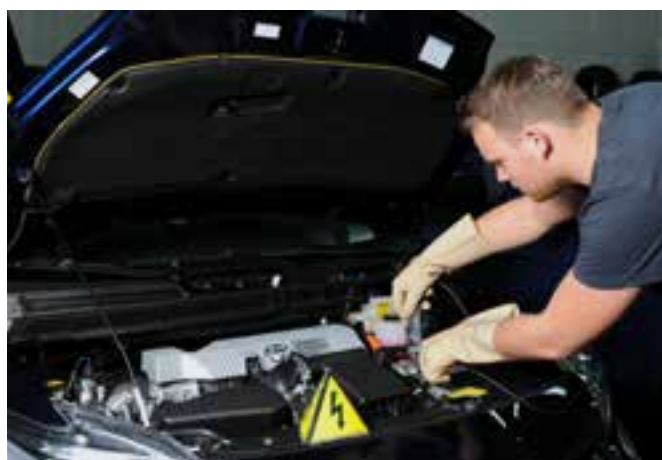
Pomiary do sprawdzenia obecności napięcia
